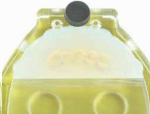
**11** Nach der vollständigen Befüllung des Kuvettenoberteils kann die gesamte Kuvette zur Aushärtung des Klarsilikons in einen Drucktopf gestellt werden
