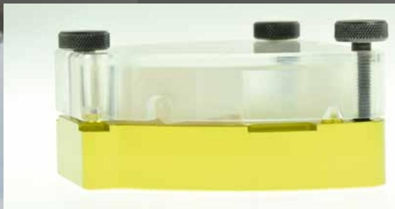
**24** Nach dem Befüllen werden die Küvettenhälften locker aufeinander gesetzt und zusammengedrückt, bis ein Widerstand spürbar ist. Daraufhin werden die drei Fixierschrauben einge-setzt und mit jeweils ein bis zwei Umdrehungen pro Schraube nacheinander zuge-dreht
